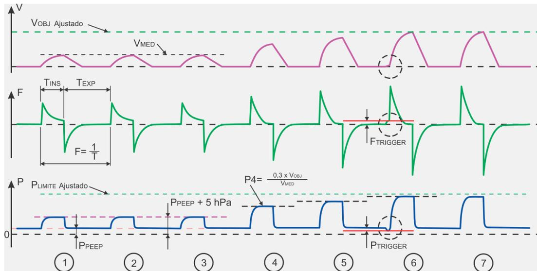
Una vez que todos los parámetros de ventilación se ajustan en el ventilador, éste calcula el T<sub>EXP</sub> en función de Frecuencia y T<sub>INS</sub>P, obteniendo de esta manera todos los tiempos de control de la ventilación.
