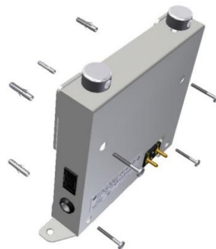
Figura 8: Instalação do suporte fixo
