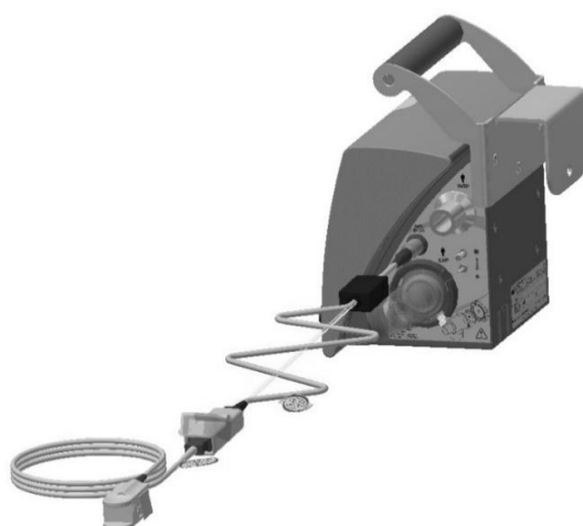
Figura 34: Montagem do sensor de oximetria.
