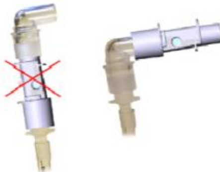
Figura 32: Posicionamento incorreto e correto do adaptador de vias aéreas
