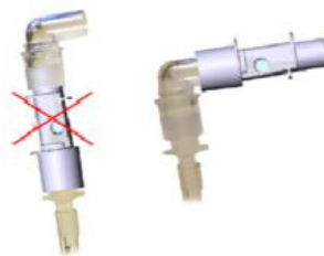
Ilustración 2- Posicionamiento incorrecto y correcto del adaptador de vías aéreas
