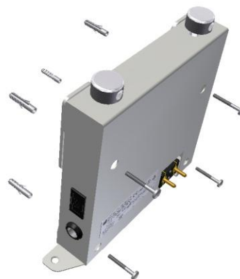
Figura 5: Instalação do suporte fixo
