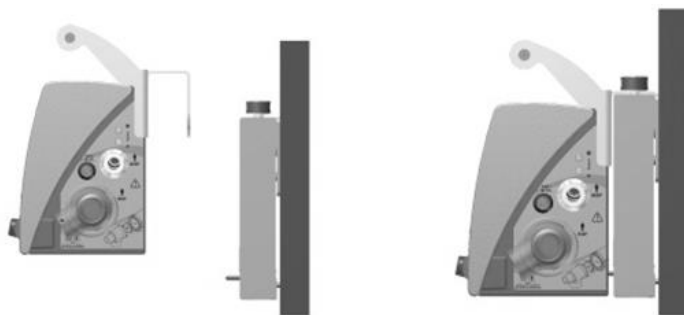
Figure 9: Connexion du ventilateur au support mural
