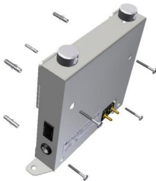
Figura 4 : Instalación de soporte fijo
