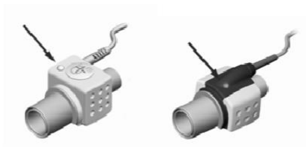
Figura 10: LED indica si el sensor está pronto para su uso
