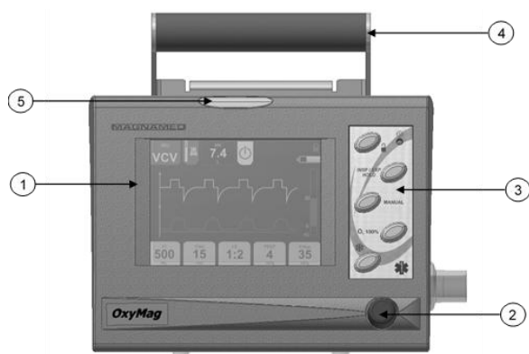
Figura 1: Painel Frontal do ventilador de transporte.
