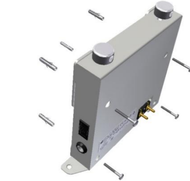
Figura 8: Instalación de soporte fijo
