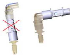
Figura 2 – Posicionamento incorreto e correto do adaptador de vias aéreas
