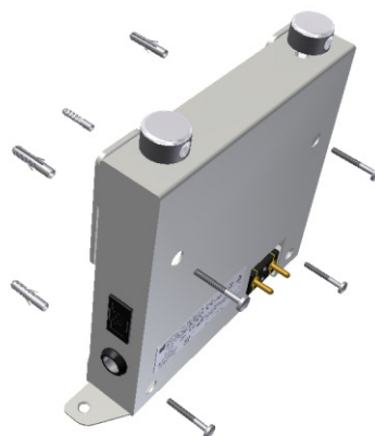
Figura 11: Instalação do suporte fixo
