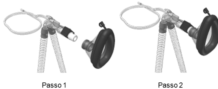
Figura 8: Montagem da máscara não invasiva com o capnógrafo
