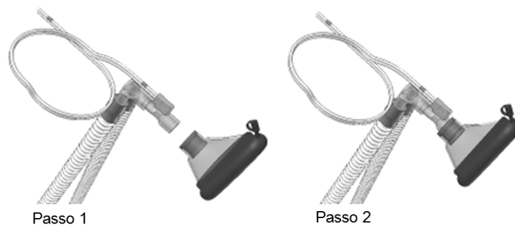
Figura 9: Montagem da máscara não invasiva sem filtro HME
