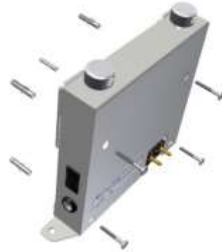
Figura 8: Instalação do suporte fixo
