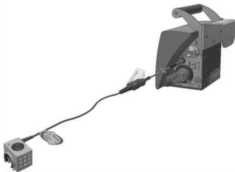
Figura 12: Encaixe do capnógrafo no Oxymag
