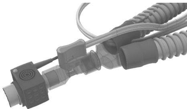
Figura 15: Conexão do adaptador de vias aéreas ao sensor de fluxo do Circuito Respiratório
