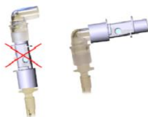
Рисунок 2. Неправильное и правильное расположение адаптера воздуховода
