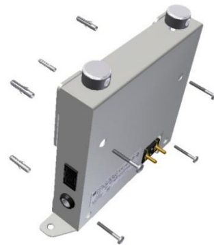
Figura 8: Instalação do suporte fixo
