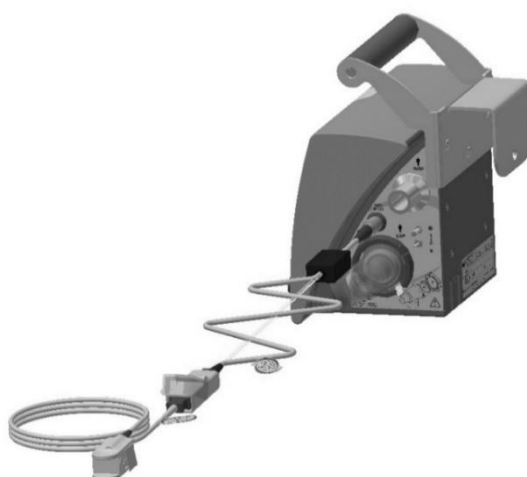
Figura 19: Montagem do sensor de oximetria.
