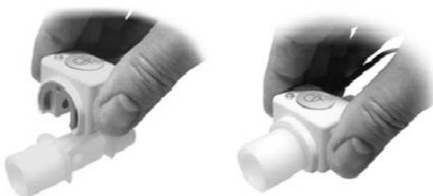
Figura 13: Encaixe do sensor de vias aéreas
