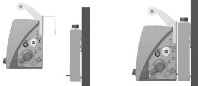
Figura 9: Conexão do ventilador ao suporte fixo
