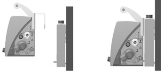
Figura 9: Conexão do ventilador ao suporte fixo
