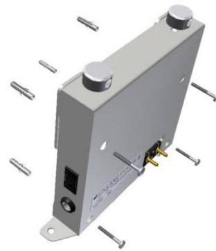
Figura 8: Instalação do suporte fixo
