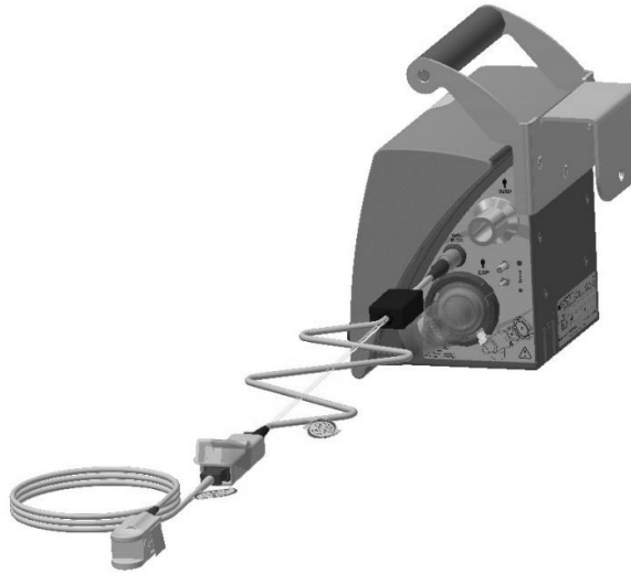
Figura 19: Montaje del sensor de oximetría.
