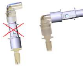
Figura 13 – Posicionamiento incorrecto y correcto del adaptador de vías aéreas
