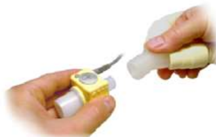
Figura 10 – Conexión del adaptador de vías aéreas a la pieza Y del Circuito Respiratorio
