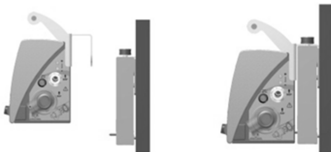
Figura 6: Conexão do ventilador ao suporte fixo
